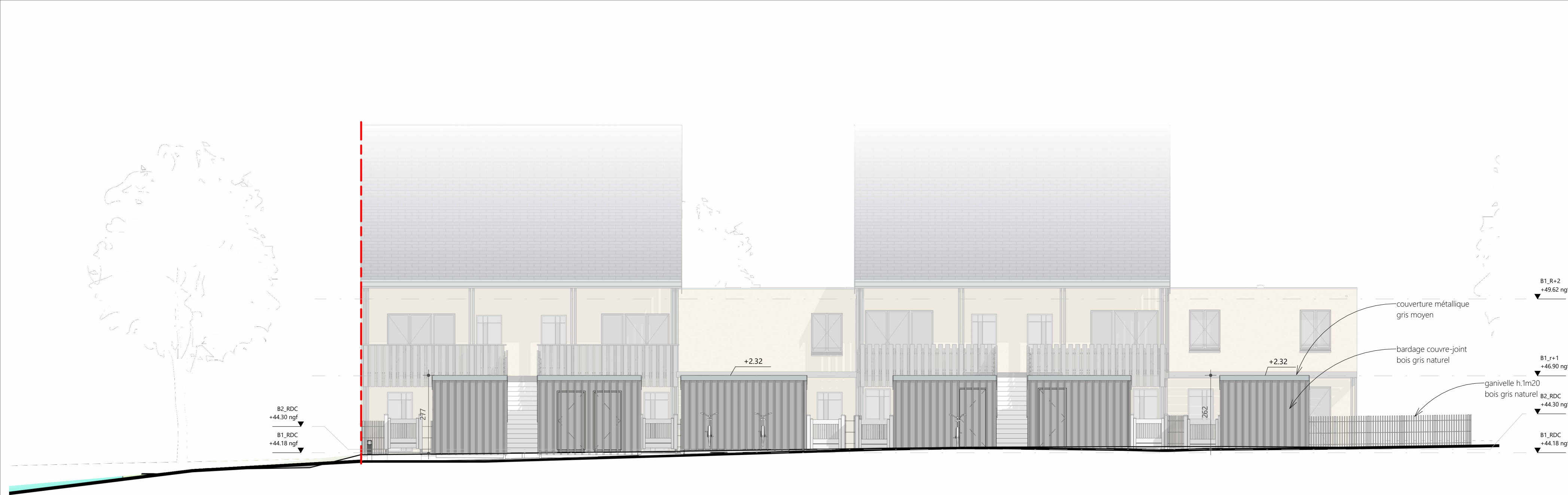
3 Élévation B – sud-ouest 1 – Garages à vélos ECH. 1 : 100
